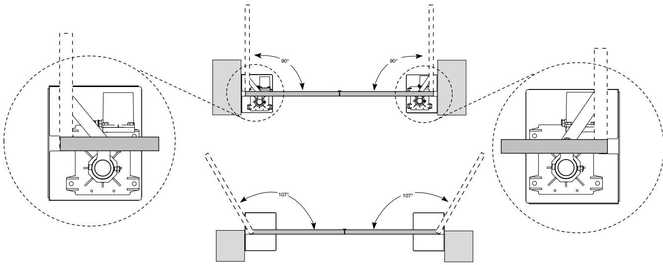
**(IT)** Inserire il motoriduttore nella cassa di fondazione nel giusto verso e fissarlo con i dadi. Applicare la leva di trasmissione inserendola tra il braccio del motore ed il gruppo di sblocco appena saldato. Sistemare una battuta di arresto in chiusura ed in apertura (oppure utilizzare art. 218)
