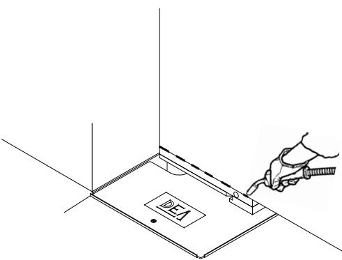
**(IT)** Eseguire uno scavo per la fondazione della cassa come dimensioni indicate. Provvedere anticipatamente allo scarico per l'acqua (con sbocco in un fondo di ciottoli adatto al drenaggio) ed alla canaletta per i cavi elettrici che deve derivare in una scatola elettrica per garantire la protezione delle giunzioni dal contatto con l'acqua.
