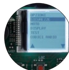
AUTO-PROGRAMMATION AU MOYEN D'UN AFFICHEUR LCD GRAPHIQUE ELDOM34/6
